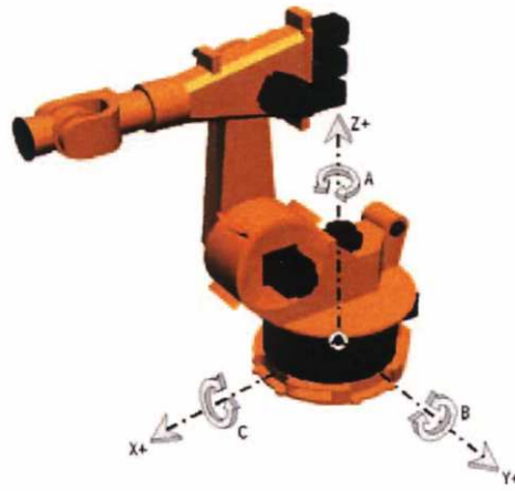
(Fig.4.2-12) Movimiento SPACE-MOUSE Cartesiano con control de la Orientación
