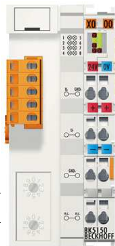
(Fig.4.5-14) Dirección CAN BUS en el módulo Beckhoff
