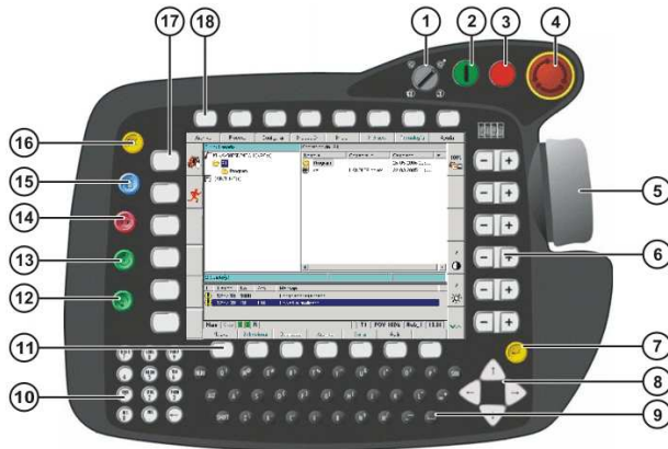
(Fig.4.2-8) Kuka Control Panel (KCP).
