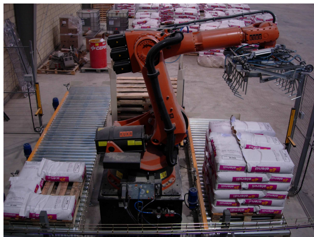
(Fig.1.3-2) Instalación de Paletizado.
