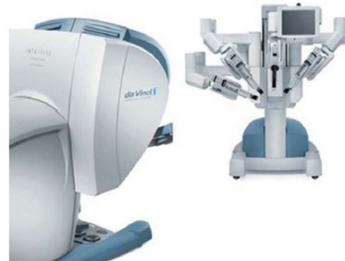
Elementos del robot cirujano da Vinci S (consola y soporte con manipuladores).
