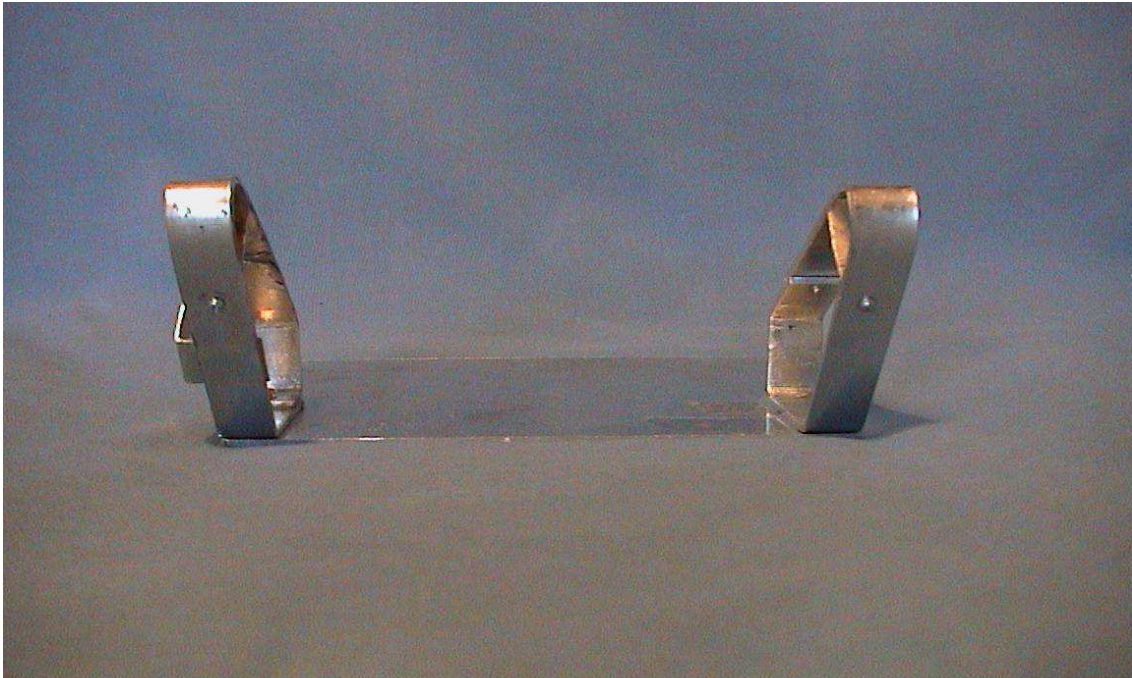
Vista frontal de la estructura de soporte, sin ejes y sin cámaras
