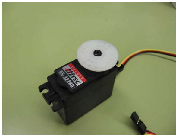
Servo de la marca Hitec, con sus 3 terminales (amarillo, rojo y negro)
