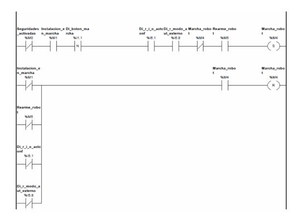
Para la activación y rearme del robot (%M5) tendrán que cumplirse las siguientes condiciones:
