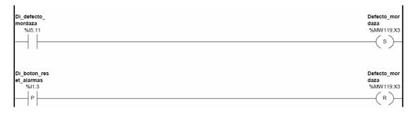
Dicho defecto sólo podrá desactivarse única y exclusivamente con el pulsador de reset del armario eléctrico, una vez que el operario haya visualizado el mensaje en el terminal XBT.
