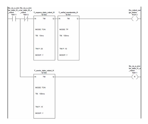
En el momento que **%M11** es resetada a través de **%TM5** en un tiempo de 1,5 segundos **%Q4.2** será desactivada. De esta manera se le indica al robot que se van a cargar los números de alturas o los números de capas, por lo tanto tendremos lo siguiente:
