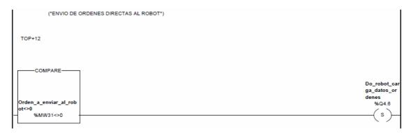
Por último, las salidas %Q4.2, %Q4.3, %Q4.4, %Q4.5, %Q4.6, %Q4.7 y %Q4.8 (DATO\_1), %Q4.9 (DATO\_1), %Q4.10 (DATO\_1), %Q4.11 (DATO\_1), y %MW31 = 0 serán reseteadas en el momento que %M11 caiga a nivel bajo nuevamente.
