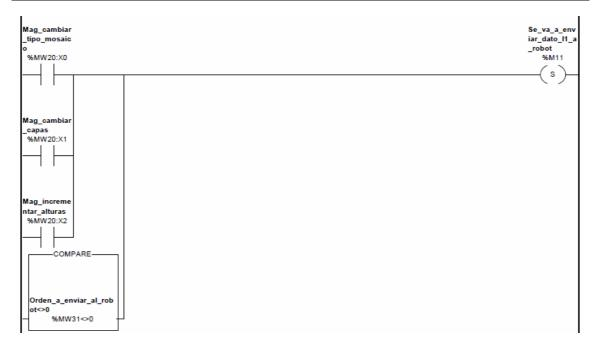
Cada vez que se procesa una orden desde el Terminal XBT se activa la marca de memoria (%M11), esto será si ejecutamos algún movimiento manual a través de los bit´s de la palabra %MW20 o si la variable %MW31 que captura el valor de la orden a través de los bit´s de la palabra %MW21 es distinto de cero. En nuestro caso las únicas órdenes que procesamos desde el XBT son las siguientes:
