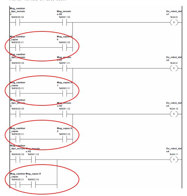
Los bit's de datos transmitirán el dato de capas, si activamos desde el XBT la variable **%MW20:X1** y los bit's de la variable **%MW2** que contienen el valor en binario que seleccionamos desde el Terminal.
