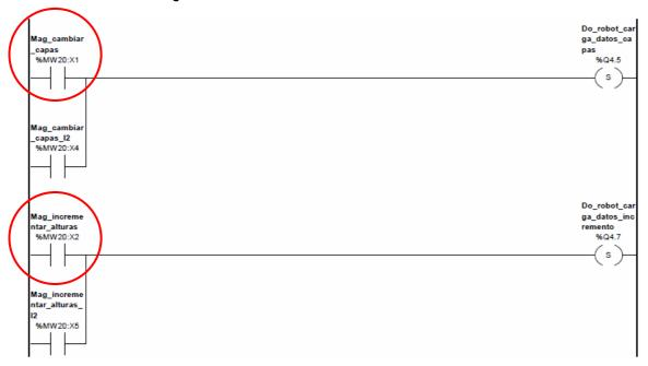
Las variables **%MW20:X4** y **%MW20:X5** no se usan en esta instalación siendo bit´s reservados para cuando haya dos líneas a los que se les puede pasar datos diferentes.
