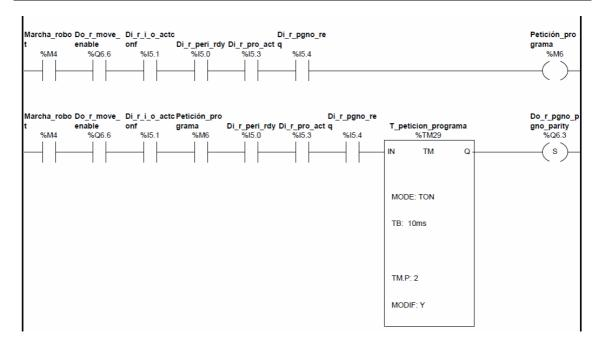
PGNO\_PARITY se encuentra temporizada de manera que al cabo e un tiempo de seguridad, y tras la confirmación del KRC mediante la señal PGNO\_REQ (%I5.4) se activará el consentimiento de lectura del PLC al KRC a través de la PGNO\_VALID (%Q6.4). Acto seguido se resetearan ambas señales transcurrido un tiempo de seguridad (%TM31) para la lectura del PLC.
