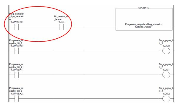
Una vez que el valor del programa es guardado en la variable **%MW118** se enviará a través de los tres primeros bits los datos al robot, mediante los bit´s PGNO BIT.
