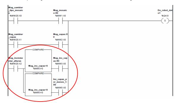
Si activamos el envío de los incrementos mediante **%MW20:X2** tenemos el caso en el que el valor sea positivo o negativo.
