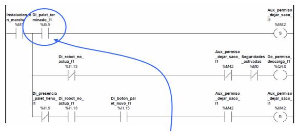
Para el caso de producirse un <u>palet terminado</u> en la línea 1, se desactivará %Q4.0 de permiso de descarga.
