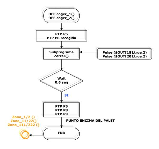
Los procesos **coger\_1** y **coger\_2**, posicionan el robot a la entrada del saco mediante movimientos de velocidad reducida. Una vez posicionado se activaran las salidas para las electroválvulas de cierre de dedos y manos mediante un pulso mantenido de dos segundos, suficiente para la activación de las bobinas de cierre.
