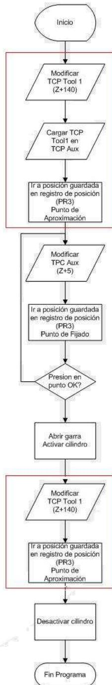
4.1.3 Fig. 1 Diagrama de flujo de un programa de posición
