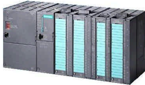
Figura 2.104 Autómata SIEMENS de la serie S7-300
