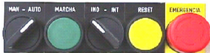
Figura 49: Botonera de control del Módulo 4
