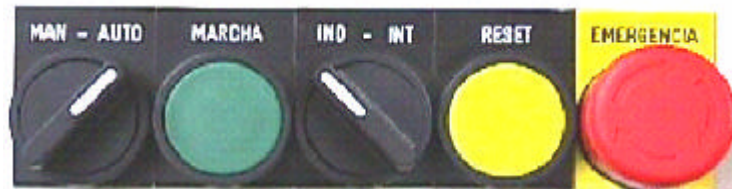
Figura 22: Botonera de control del Módulo 1
