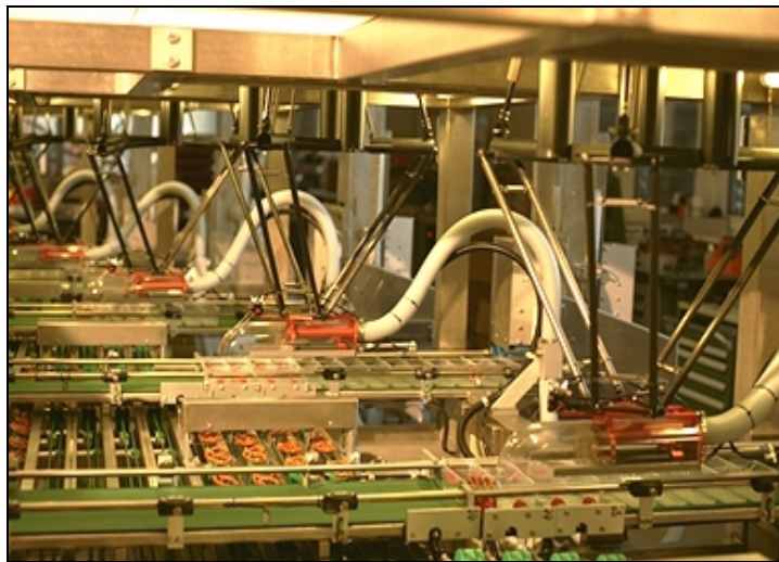
Figura 2.6 El robot Delta en la industria del empaquetado.
