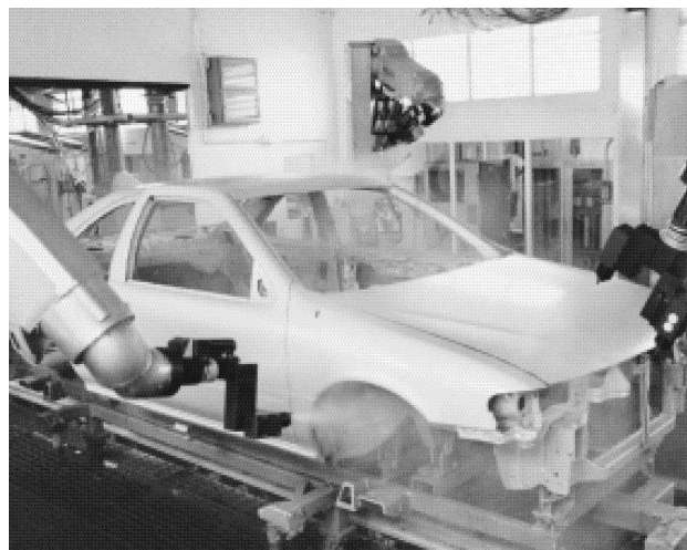
Figura 2: Aplicación automatizada de pintado de autos usando robots.
