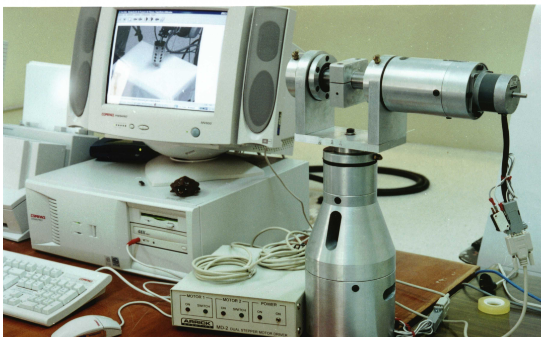
Figura 2.8: Unidad mecánica de 2 grados de libertad
