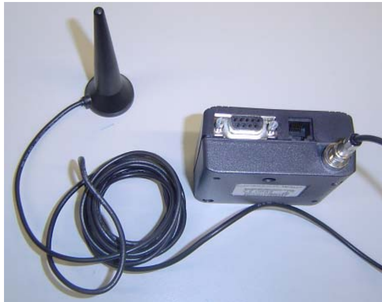
Fig. 4.11. Conexión antena magnética a MODEM
