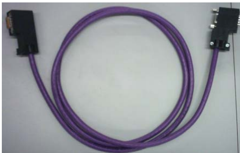
Fig. 4.5. Segmento de cable MPI
