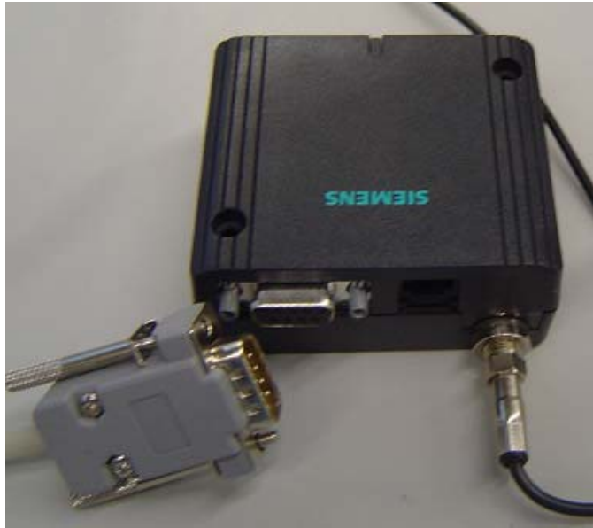
Fig. 4.12. Conexión cable de comunicación
