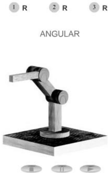
Figura 5: Ejemplo de configuración angular con posibilidad de animación realizada en 3D Studio
