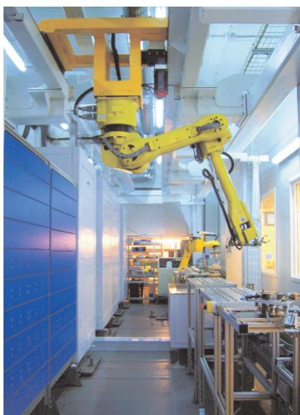
FANUC los clasifican y guardan en gradillas según el tipo de familia de la muestra. Cuando estas gradillas codificadas están completas, en el caso de muestras de alta rotación, o casi llenas en el resto de los casos, los robots las almacenan temporal-
