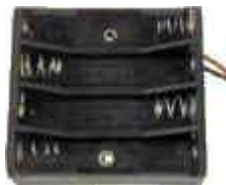
Fig34:Exemple de portapiles.
