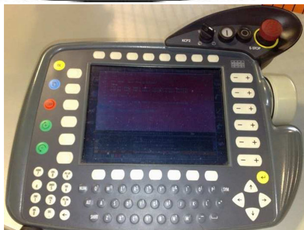
Fig. 2.31 Fotografia d'una KCP de la sala de formació
