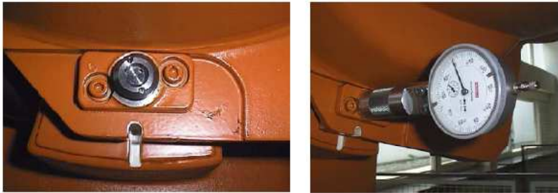
Fig. 2.8 – Ajustament amb rellotge comparador
