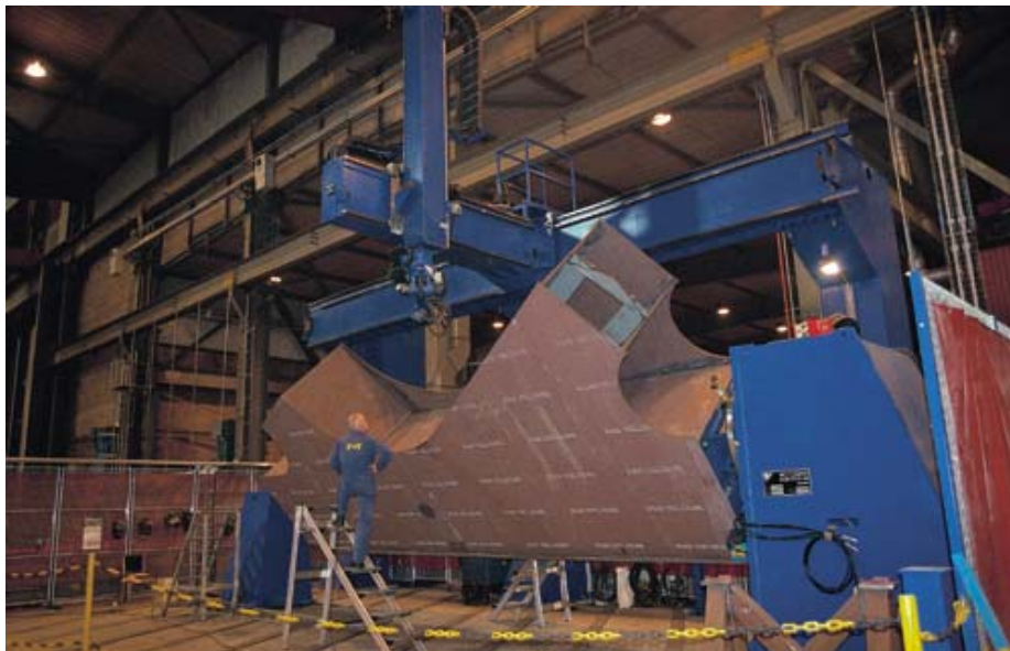
Fig.13. Célula robotizada para soldeo de grandes piezas con sistema gantry y posicionador
