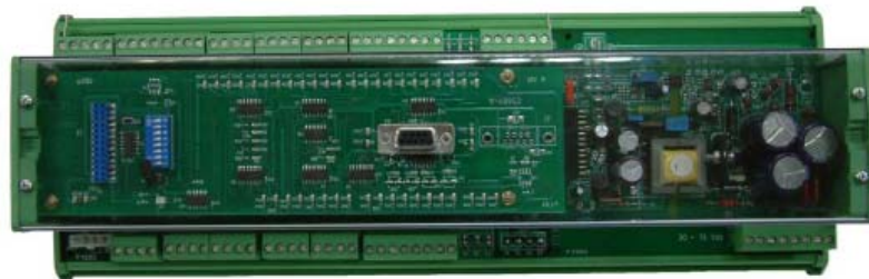
Fig.36. Interfaz analógico para fuente de potencia de Cebora.
