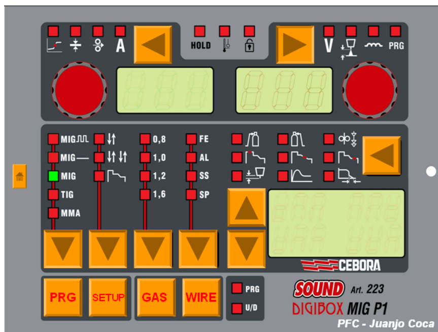
Fig.111. Panel de control y programación de jobs de soldadura de la fuente de potencia utilizada en este proyecto.
