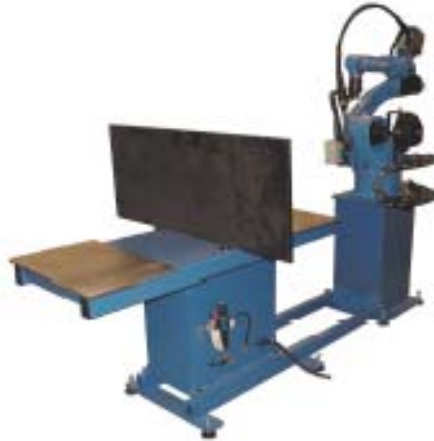
Fig.14. Mesa neumática de dos estaciones formada por una zona de carga y una zona de trabajo.
