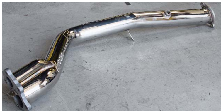
Fig.95. Ejemplo de pieza en acero con cordones de soldadura mediante el método TIG.
