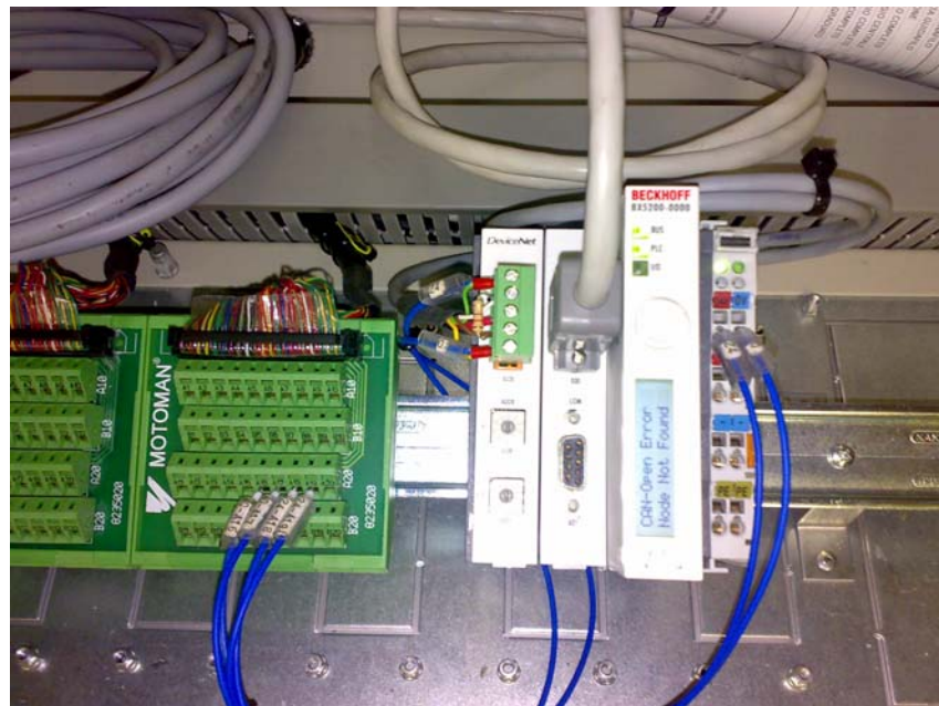
Fig.126. Cabecera Beckhoff-DeviceNet Slave para la fuente de potencia de Cebora.
