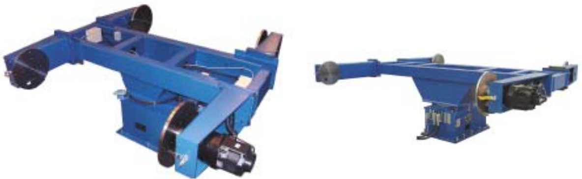
Fig.19. Imagen de ejes externos de 3 motores con una capacidad de carga de 250Kg y 1000 Kg respectivamente.
