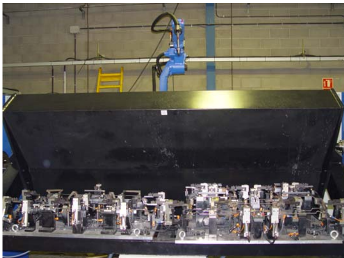
Fig.58. Utillajes con control de cierre automático y sensórica en célula robotizada.
