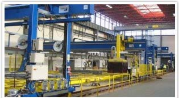
Fig.100. Imagen de la construcción del buque Juan Carlos I. Se trata de un sistema robotizable de producción de piezas con series cortas. En la industria naval se emplean células de soldadura por arco para crear módulos, que luego se unen en el astillero. (Robots en sistema gantry con corinas de protección)
