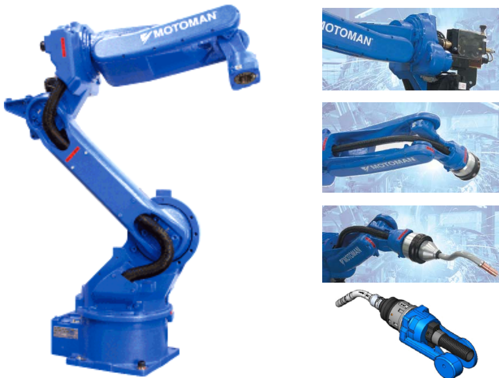
Fig.7. Modelo EA1400 de Motoman Robotics y detalles del alojamiento del equipamiento de soldadura
