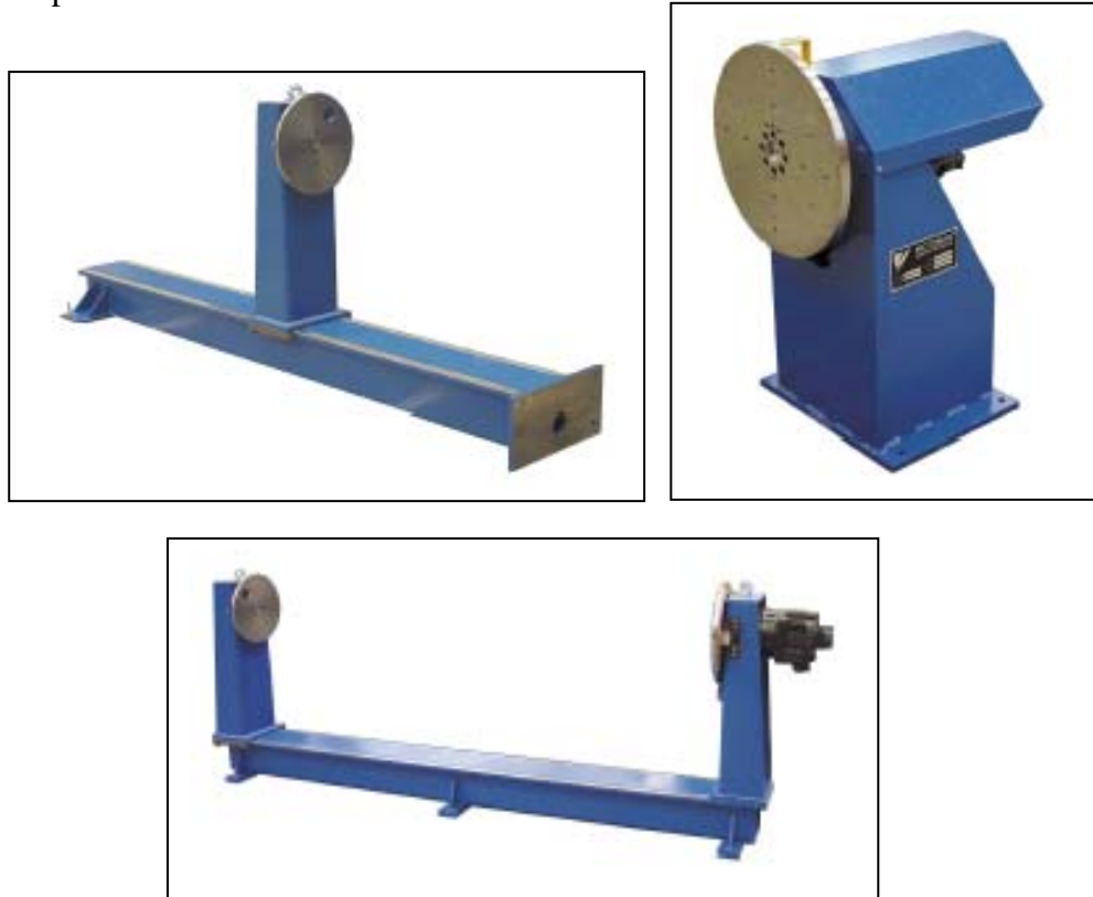
Fig.15. Eje externo de un motor para posicionar utillajes destinados a la soldadura formado por plato motriz y contraplato montado en raíles, para distintas distancias entre platos.
