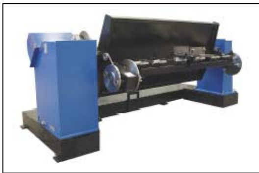
Fig.16. Imagen y características del posicionador de RM2 Motoman con motor desembragable.
