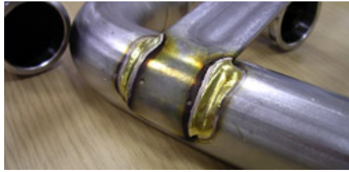
Fig.82. Cordón de soldadura MIG con Argón e hilo de cobre, en el que se pretende que la pieza no se deforme por el calor de la soldadura.
