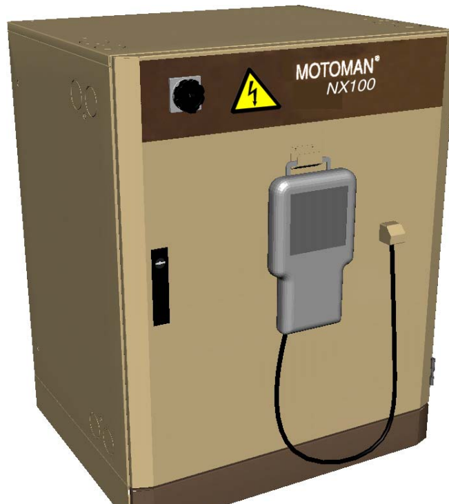
Fig.20. Imagen de la computadora NX100 de Motoman Robotics.
