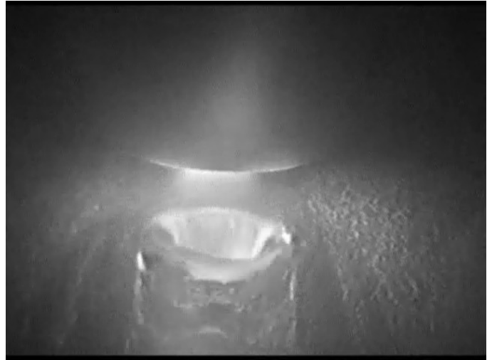
Fig.98. Soldadura por arco plasma empleando la modalidad "Keyhole" durante el proceso, y detalle de la penetración pasante mediante este método de soldadura.
