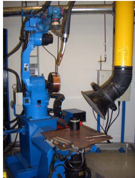
Fig.63. Detalle e imagen de instalación con brazos de aspiración móviles.
