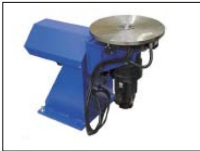
Fig.17. Imagen de 2 ejes de 2 motores con unas capacidades de carga de 250 Kg y 500 Kg respectivamente.
