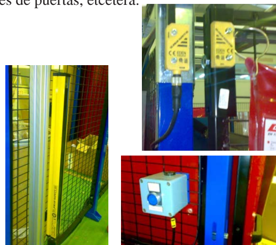
Fig.59. Esquema de ejemplo de seguridades (puerta de servicio, barrera fotoeléctrica y relés de seguridad con rearme) de una célula robotizada de Motoman Robotics.
