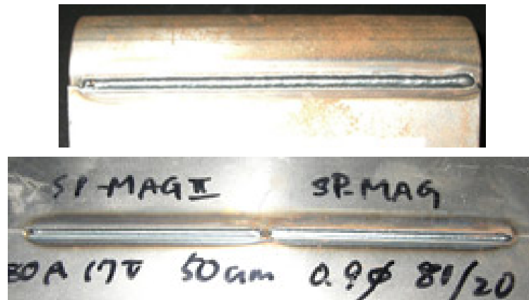
Fig.85. Cordones de soldadura MAG en acero
