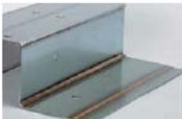
CMT brazing entre chapas galvanizadas electrolíticamente y en caliente. Espesor de la chapa 1.0 mm. Hilo de aporte CuSi3.
