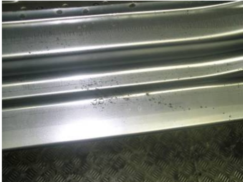
Figura 3.13.- Residuos de soldadura en zonas vistas de la carrocería
