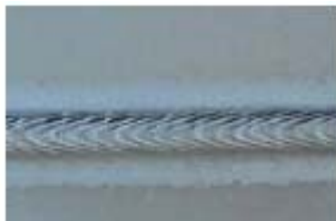
Soldadura en angulo sobre chapa de 1mm AlMg3 con velocidad de soldadura de 2m/min.
