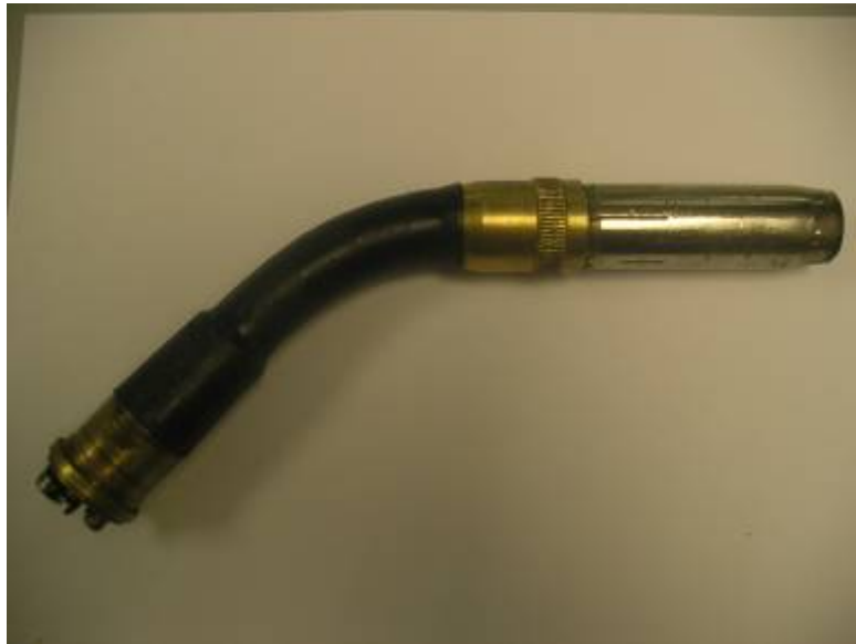
Figura 3.18.- Antorcha de soldadura deteriorada
