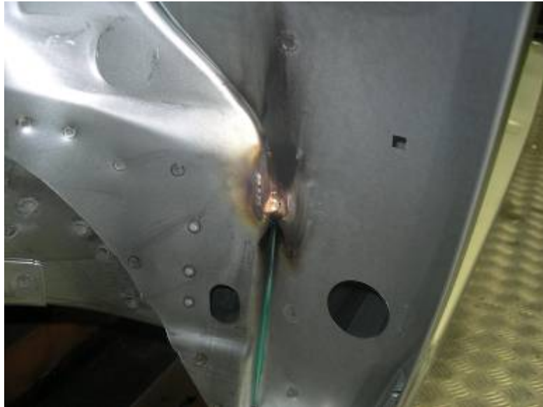
Figura 3.15.- Ejemplo se soldadura irregular
