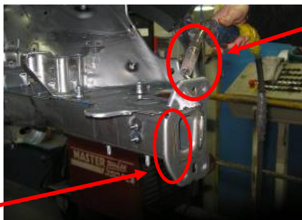
Figura 1.5.-Soldadura por transparencia y soldadura manual
