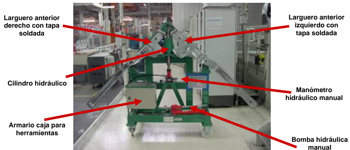
Figura 2.10.- útil de prueba destructiva de largueros
