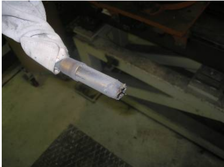
Figura 3.14.- Residuos de soldadura incrustados en la herramienta del robot.
