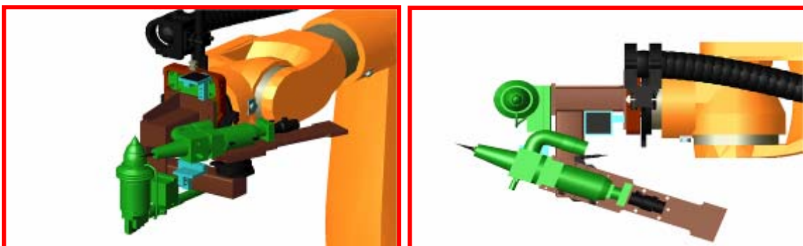
Figura 2.5.-Imagen de Robcad de los cabezales de corte y soldadura
