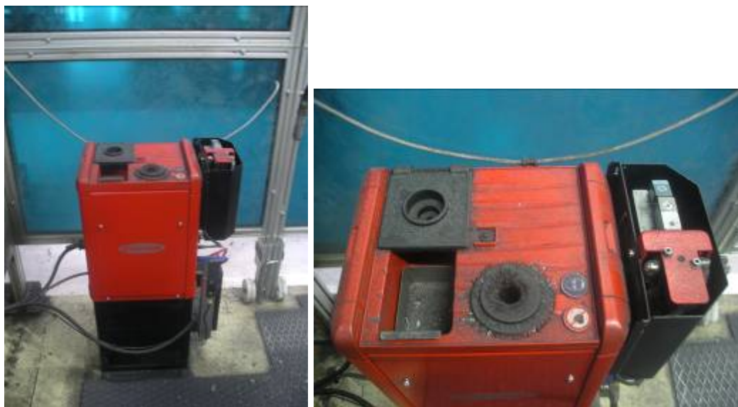
Figura 3.16.- Sistema de fresado electromagnético Touchless-Cleaner .
