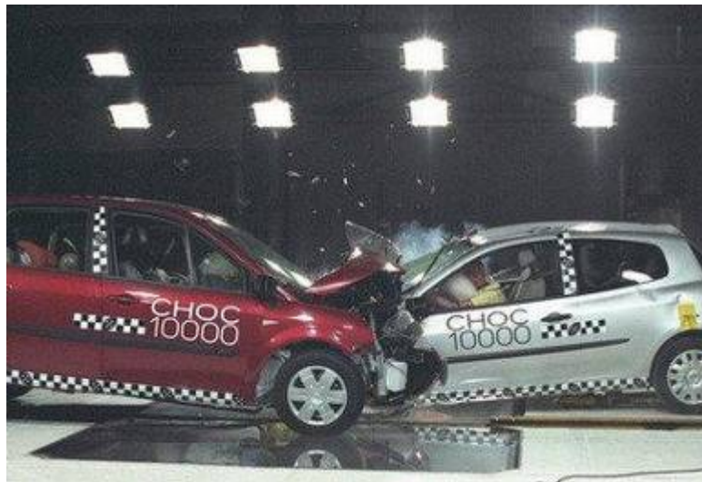
Figura 1.3.-Prueba de crash entre dos vehículos de clase media.
