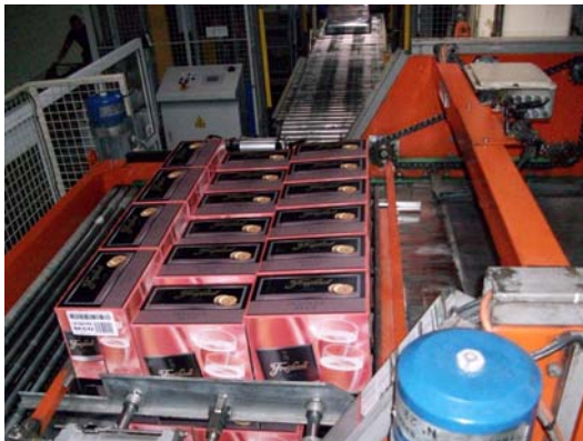
Figura 2.5.4: Resultat maquina treballant, deixant capa en palet
