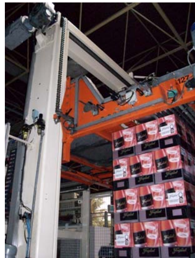
Figura 2.5.4: Resultat maquina treballant, deixant capa en palet
