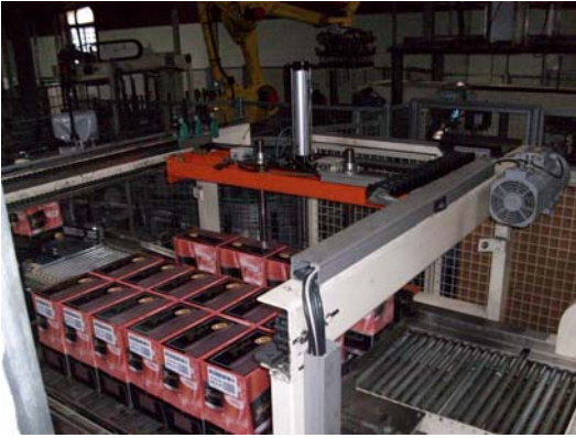
Figura 2.5.3: Resultat maquina treballant, formació de capa
