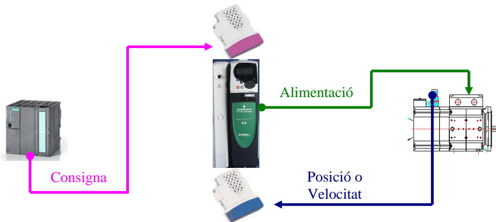
Figura 2.2.3.12: Conjunt control posicionament o velocitat.
