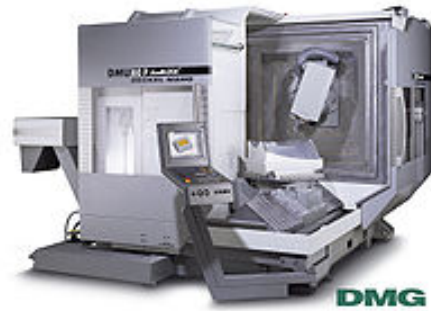
Figura 5: Fresadora CNC de cinc eixos amb capçal i taula giratòria [W.3]
