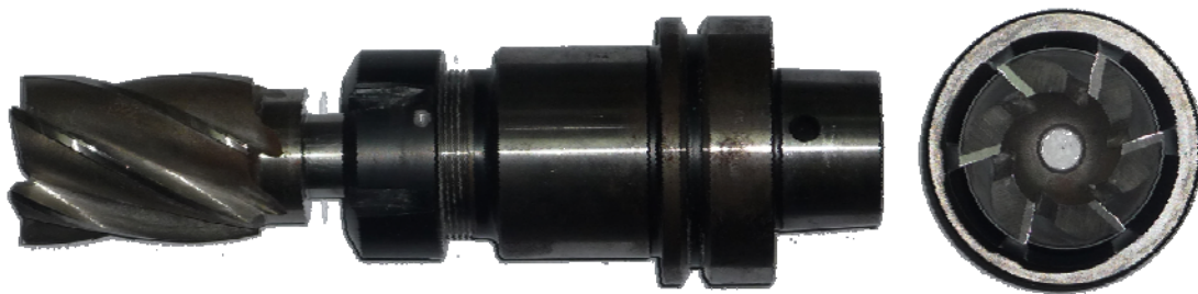
Figura 51: Eina de Tall emprada en l'Experiment
