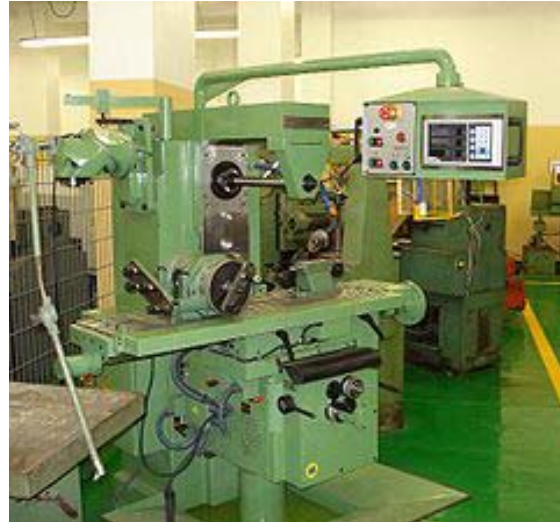
Figura 2: Fresadora universal amb els seus accessoris [W.19]
