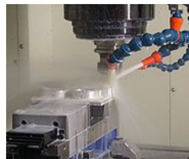
Figura 10: Fresat d'alumini utilitzant taladrina [W.19]
