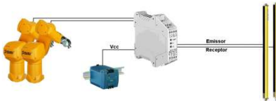
Figura 5.8. Diagrama de connexió de les barreres òptiques Leuze
