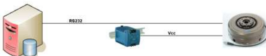
Figura 5.6. Diagrama de connexió del sensor de força Schunk FTCL
