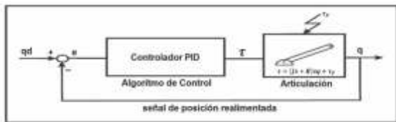
Tomado de: Autores Figura 13. Diagrama del control PID para una articulación independiente.
